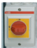
Interruttore marcia-arresto montato a bordo
