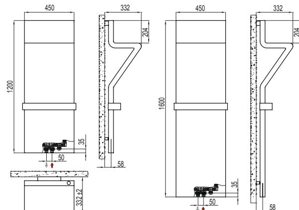
**Dotazione di serie:** innovativo sistema di collegamento idraulico a scomparsa, installato sul prodotto, completo di raccordi per allacciamento con tubi rame (diametri 12, 14 e 16 mm) e multistrato (14 sp. 2 e 16 sp. 2), sistema per fissaggio a muro; maniglia porta accessori; sistema di illuminazione a led opzionale; valvola sfiato.
