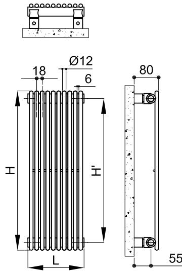
(\*) Grazie alle elevate prestazioni dei radiatori Arpa12, il  $\Delta t$  ideale per la progettazione a bassa temperatura è il  $\Delta t$  a 30°C. Per  $\Delta t$  diversi da 50°C utilizzare la formula:  $Q=Qn (\Delta t / 50)^n$
