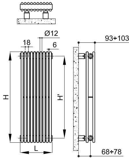
(\*) Grazie alle elevate prestazioni dei radiatori Arpa12\_2, il  $\Delta t$  ideale per la progettazione a bassa temperatura è il  $\Delta t$  a 30°C. Per  $\Delta t$  diversi da 50°C utilizzare la formula:  $Q=Qn (\Delta t / 50)^n$
