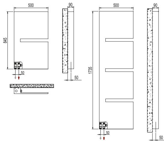
**Dotazione di serie:** innovativo sistema di collegamento idraulico a scomparsa, installato sul prodotto, completo di raccordi per allacciamento con tubi rame (diametri 12, 14 e 16 mm) e multistrato (14 sp. 2 e 16 sp. 2); sistema per fissaggio a muro incorporato alla colonna del prodotto; valvola sfiato.
