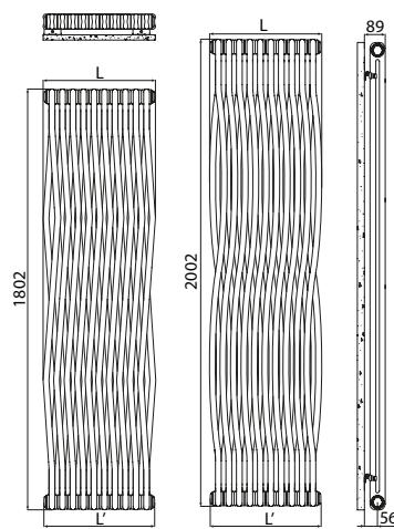
(\*) Grazie alle elevate prestazioni dei radiatori Tesi Join, il  $\Delta t$  ideale per la progettazione a bassa temperatura è il  $\Delta t$  a 30°C. Per  $\Delta t$  diversi da 50°C utilizzare la formula:  $Q=Qn (\Delta t / 50)^n$
