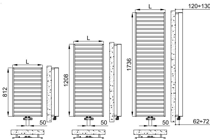
**Dotazione di serie:** valvole a quadro passo 50 mm in tinta con il radiatore, completi di raccordi rame (diametri 12 e 14 mm) e multistrato (14 sp. 2 e 16 sp. 2); kit copri tubi (adatto per tubi fino a 16 mm di spessore); 4 fissaggi a muro; valvola sfiato cromata; 1 mensola porta salviette in tinta con il radiatore.
