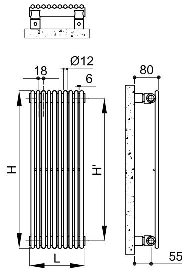
(\*) Grazie alle elevate prestazioni dei radiatori Arpa12 Cromato, il  $\Delta t$  ideale per la progettazione a bassa temperatura è il  $\Delta t$  a 30°C. Per  $\Delta t$  diversi da 50°C utilizzare la formula:  $Q=Qn(\Delta t / 50)^n$
