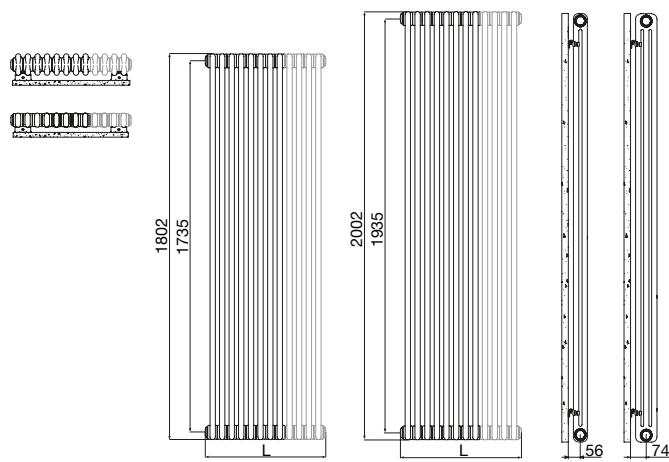
(\*) Grazie alle elevate prestazioni dei radiatori Tesi Cromato, il  $\Delta t$  ideale per la progettazione a bassa temperatura è il  $\Delta t$  a 30°C. Per  $\Delta t$  diversi da 50°C utilizzare la formula:  $Q=Qn (\Delta t / 50)^n$
