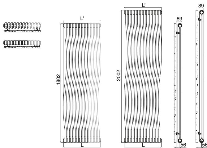
(\*) Grazie alle elevate prestazioni dei radiatori Tesi Runner, il  $\Delta t$  ideale per la progettazione a bassa temperatura è il  $\Delta t$  a 30°C. Per  $\Delta t$  diversi da 50°C utilizzare la formula:  $Q=Qn (\Delta t / 50)^n$
