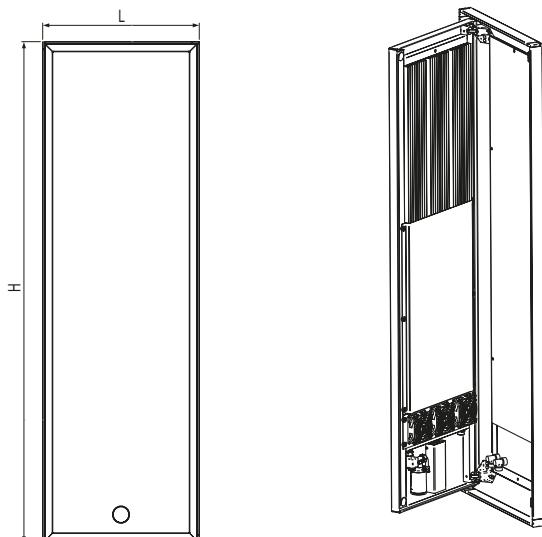
**Dotazione di serie:** 2 detentori 1/2" M, 1/2" F attacco FE; flessibili per facilitare l'installazione; sistema di fissaggio a muro; 1 alimentatore e 1 testa termostatica modulante.
