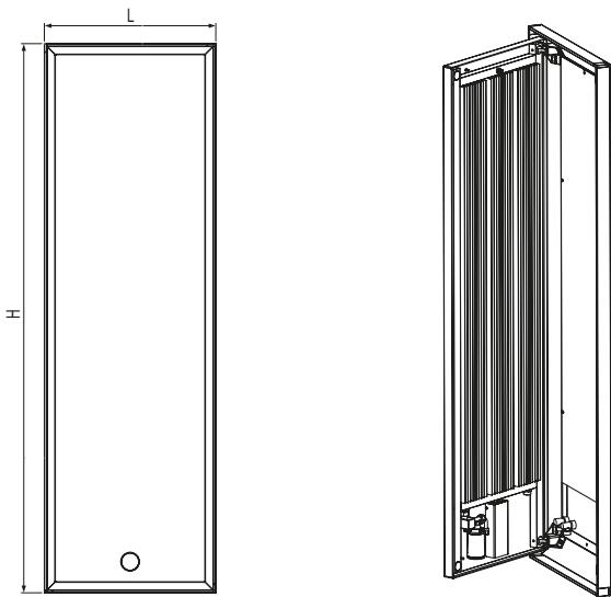
**Dotazione di serie:** 2 detentori 1/2" M, 1/2" F attacco FE; flessibili per facilitare l'installazione; sistema di fissaggio a muro; 2 batterie e una testa termostatica modulante.
