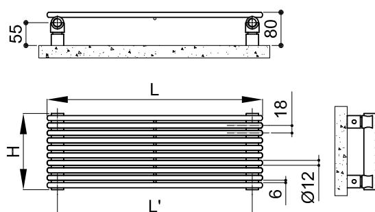
**LAVORAZIONI SPECIALI:** predisposizione per attacchi laterali con allacciamenti idraulici 1/2" saldati e diaframma interno.
