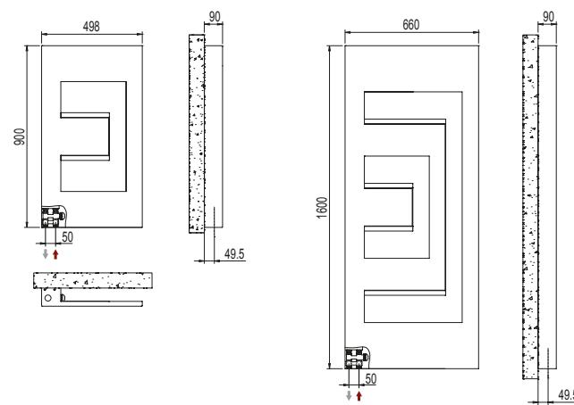
**Dotazione di serie:** innovativo sistema di collegamento idraulico a scomparsa, installato sul prodotto, completo di raccordi per allacciamento con tubi rame (diametri 12, 14 e 16 mm) e multistrato (14 sp. 2 e 16 sp. 2), sistema per fissaggio a muro incorporato alla colonna del prodotto; sistema di illuminazione a led opzionale; valvola sfiato.
