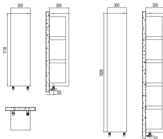
**Dotazione di serie:** valvola e detentore a quadro, in tinta con il radiatore, completi di raccordi rame (diametri 12, 14 e 16 mm) multistrato (14 spessore 2 e 16 spessore 2); kit copri tubi (adatto per tubi fino a 16 mm di spessore); 4 supporti a muro; valvola sfiato.
