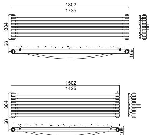
(\*) Grazie alle elevate prestazioni dei radiatori Tesi Cruise, il  $\Delta t$  ideale per la progettazione a bassa temperatura è il  $\Delta t$  a 30°C. Per  $\Delta t$  diversi da 50°C utilizzare la formula:  $Q=Qn (\Delta t / 50)^n$
