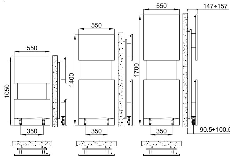
**Dotazione di serie:** innovativo sistema di collegamento idraulico a scomparsa, installato sul prodotto, completo di raccordi per allacciamento con tubi rame (diametri 12e 14 mm) e multistrato (14 sp. 2 e 16 sp. 2); sistema per fissaggio a muro incorporato alla colonna del prodotto; valvola sfiato.
