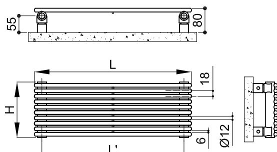
**LAVORAZIONI SPECIALI:** predisposizione per attacchi dal laterale con allacciamenti idraulici 1/2" saldati e diaframma interno.
