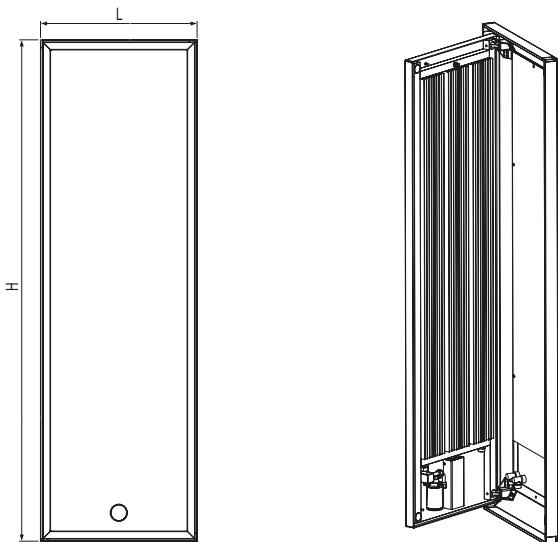
**Dotazione di serie:** 2 detentori 1/2" M, 1/2" F attacco FE; flessibili per facilitare l'installazione; sistema di fissaggio a muro; 2 batterie e una testa termostatica modulante.
