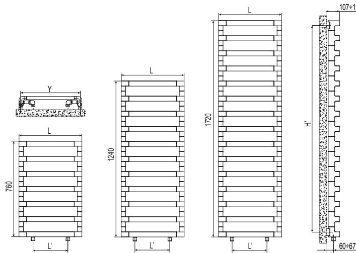
**Dotazione di serie:** 4 attacchi per fissaggio a muro nella stessa finitura del radiatore; 2 valvole sfiano da 1/2" a scomparsa e coprivalvole; kit idraulico premontato della stessa finitura del radiatore.
